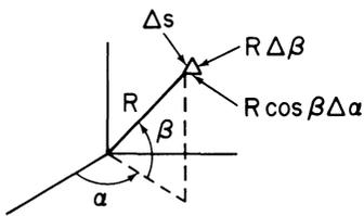
Fig. 18. Coordinate system for latitude and longitude
